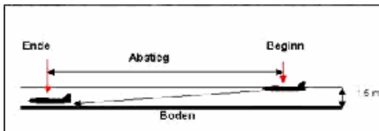
Das Modell beginnt mit stehendem Motor den Ladeanflug bei Unterschreitung der Normalflughöhe von 1,5 m. Es setzt nach mindestens einer halben Runde auf dem Boden auf und rollt aus.
