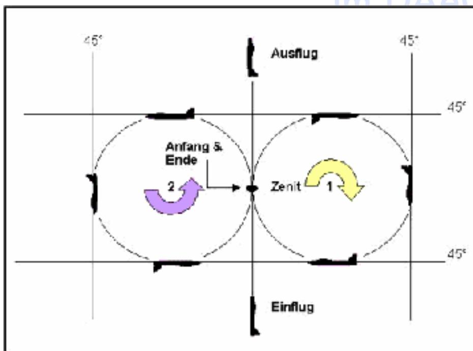
Das Modell geht aus dem Horizontalflug in einen senkrechten Steigflug über. Die Figur beginnt im Zenit mit einem Innenlooping, der die 45°-Ebene berührt. Befindet sich das Modell wieder im Zenit schließt sich ein Außenlooping an, der ebenfalls die 45°-Ebene berührt. Die Figur endet im Zenit. Ein senkrechter Sturzflug leitet die Figur in die Normalflugebene aus.
