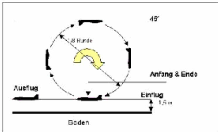
Das Modell beginnt die Flugfigur aus der Normalfluglage in Höhe von 1,5 m über dem gedachten Horizont. Der Scheitelpunkt des Loopings soll  $45^\circ$  betragen.
